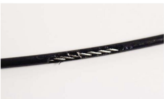
Разрыв покрытия троса
